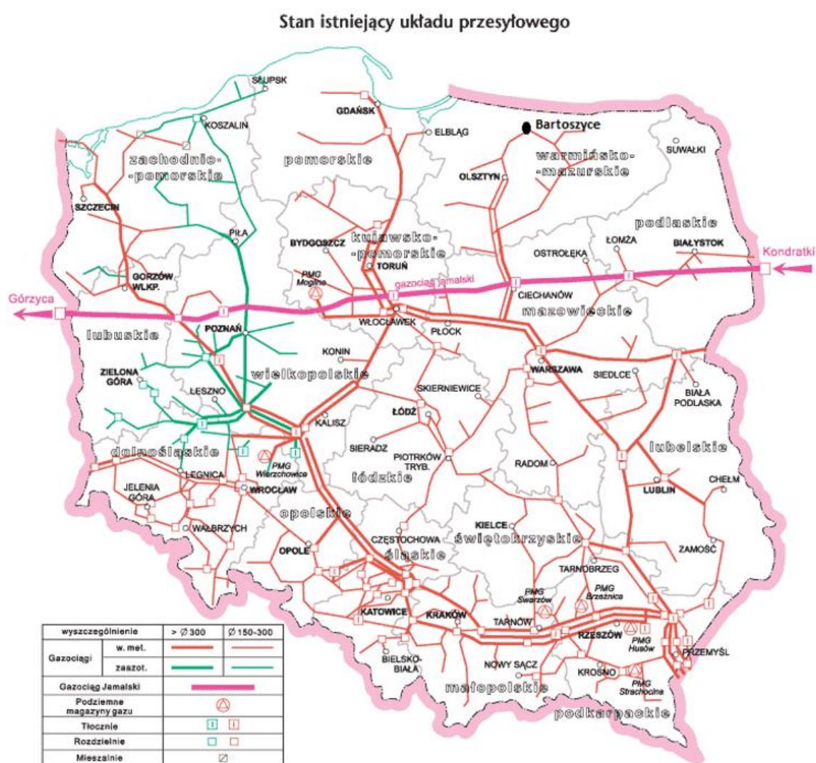
RYSUNEK 3. SIEĆ PRZESYŁOWA I DYSTRYBUCYJNA W POLSCE.
